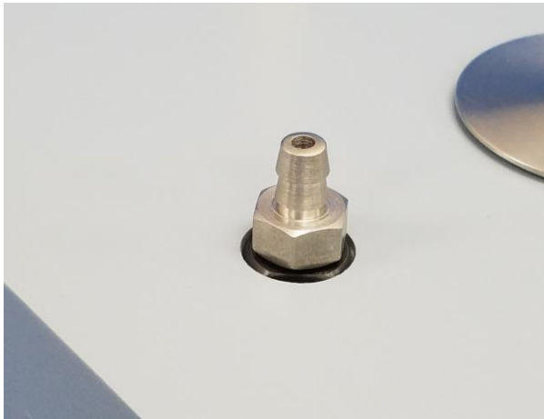
Figure 5. Mini Vapor Pin® Installation Complete
