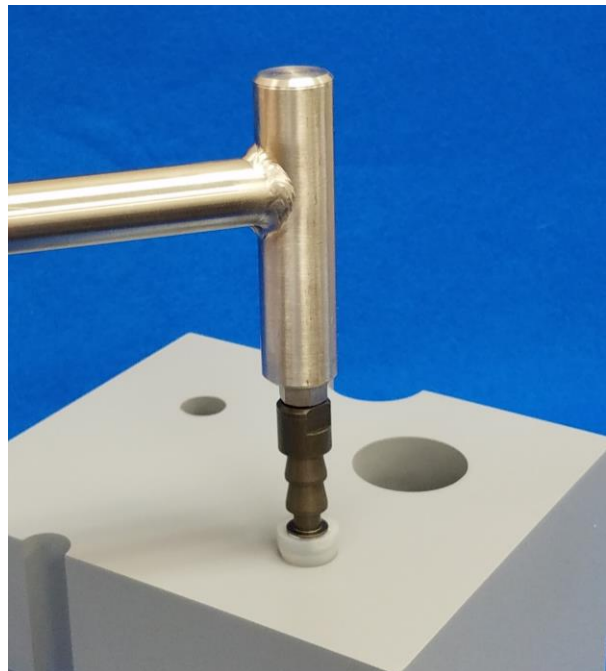
Figure 4. Mini Vapor Pin® Installation (Step 2)
