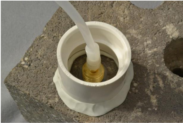
Figura 3. Tubo di contenimento per test
